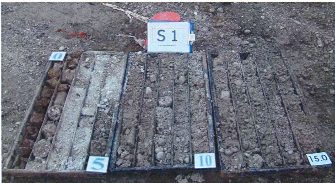
Foto n. 2: carota estratta fino a 15 m di profondità (sondaggio S1).
