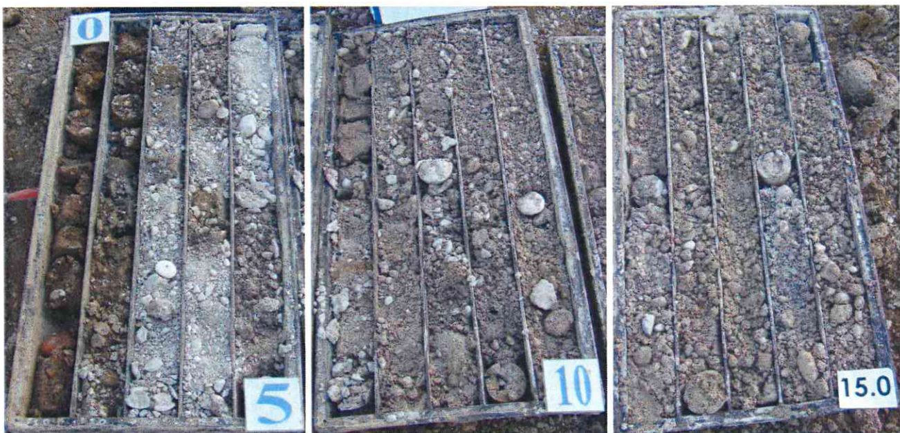
Foto n. 6: carota estratta fino a 15 m di profondità (sondaggio S3).
