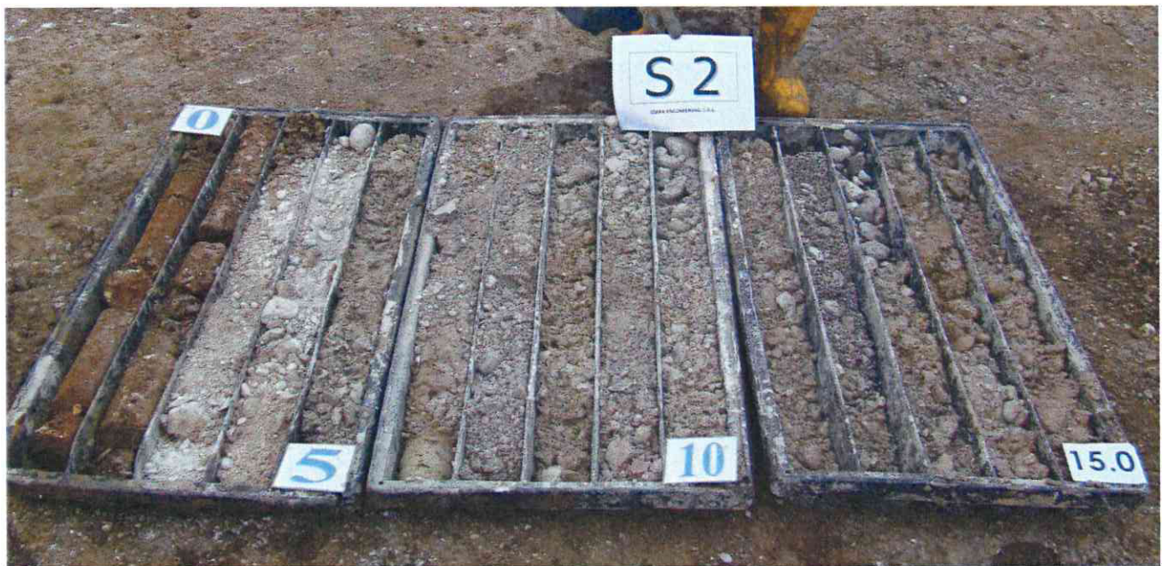
Foto n. 4: carota estratta fino a 15 m di profondità (sondaggio S2).
